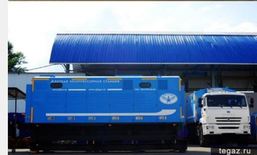
Работает при температуре окружающей среды : - 60 .. + 50 °C
